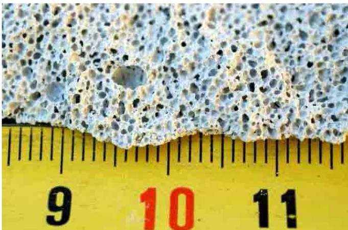
Газобетон в строительстве практически универсален: он одновременно является несущим и теплоизоляционным материалом и позволяет возводить одно- и многоярусные наружные ограждающие стены толщиной от
